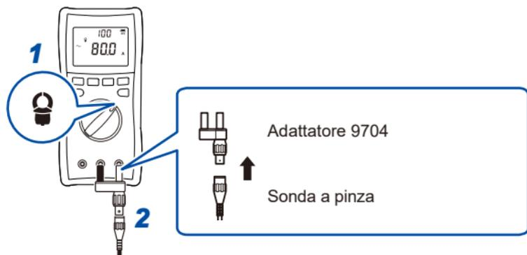
Imposta la sonda a pinza e lo strumento sulla stessa gamma.
