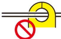
**Non bloccare lo strumento attorno a due o più conduttori.**
